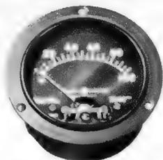
**Milliamperemeter.** Skala 0-100. Endausschlag 1,2 mA. Flansch  $\varnothing$  65, Gehäuse  $\varnothing$  53, Tiefe 27 mm. Ri 10 Ohm. Leuchtzeichen . . . . . DM 8.—
