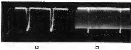
Bild 8. Oszillogramm der Synchronisierungssignale an der Anode der EH 90 in Bild 7. a) Zeile, b) Bild, jeweils 75 V<sub>ss</sub>
