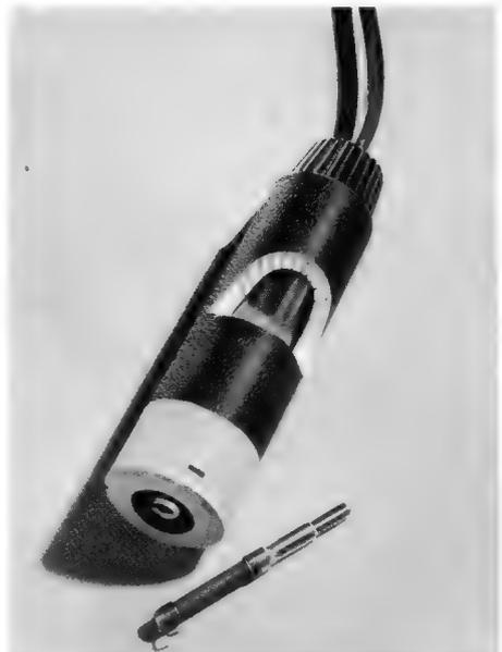
Bild 3. Das gebrauchsfertige Instrument, vorn der einsteckbare Tastwiderstand
