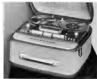
unterricht. Mit Hilfe der eingebauten Tricktaste können nachträglich in eine fertige Aufnahme bestimmte Effekte eingesprochen werden. Zur Bedienungserleichterung wurden getrennte Lautstärkeregler für Aufnahme und Wiedergabe vorgesehen, und ferner wurde der Hf-Oszillator stabilisiert und so ausgelegt, daß sich die Vormagnetisierung für beide Sprechköpfe getrennt einstellen läßt. Die Spurumschaltung erfolgt elektrisch mit Hilfe einer Taste (Grundig Radio-Werke, Fürth).
